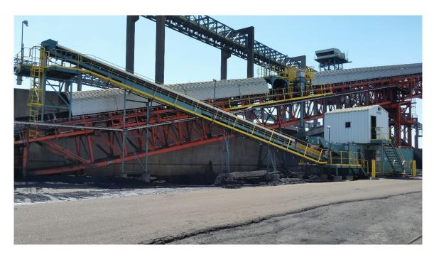
시스템의 핵심 구성 요소는 아래에 나열되어 있으며 75mm x 0(3 인치 x 0) 이하의 제품을 수용할때는 ASTM 표준을 충족시키거나 초과하도록 작동합니다. 샘플링 시스템은 위탁화물 1,000 톤까지의 특수 샘플 요청을 수용하기 위해 여러 벨트 속도 및 커터 주파수에서 작동하도록 맞출 수 있습니다.
