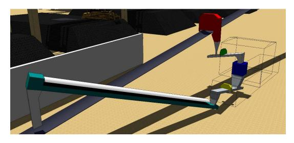
1 차 샘플러 - 이 교차 벨트 장치(빨간색)는 C-3 컨베이어(검정색)의 최소 1.5 배 속도로 작동하며 50 초마다 50kg(111 파운드)씩 추출합니다. 커터 구멍의 폭은 230mm(9.2 인치)입니다. 이 장치의 이송 슈트에는 플러그 슈트 인디케이터 및 바이브레이터가 설치되어 재료 흐름을 원활하게 합니다. 샘플 재료는 1 차 공급 컨베이어로 중력 공급됩니다.
