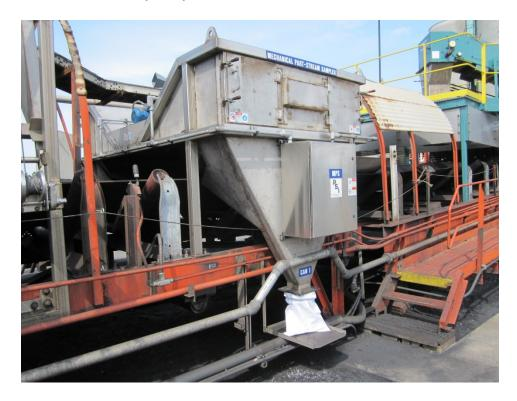
기계 파트 스트림 샘플러(Mechanical Part-stream Sampler, MPS)는 주로 대체용 기계 샘플링 장치로서 AS(선적 시 기계 샘플링 시스템)가 작동하지 않을 때 사용할 수 있습니다. 이 백업 샘플링 장치를 사용하면 작업자가 컨베이어에서 수동으로 샘플 채취를 할 필요가 없으므로 샘플링 작업과 관련된 잠재적 안전 위험을 피할 수 있습니다. MPS는 AS 와 함께 사용되며 크기 분석 또는 기타 특수 시험을 위해 분쇄되지 않은 샘플 물질을 추가로 수집할 수 있습니다.
