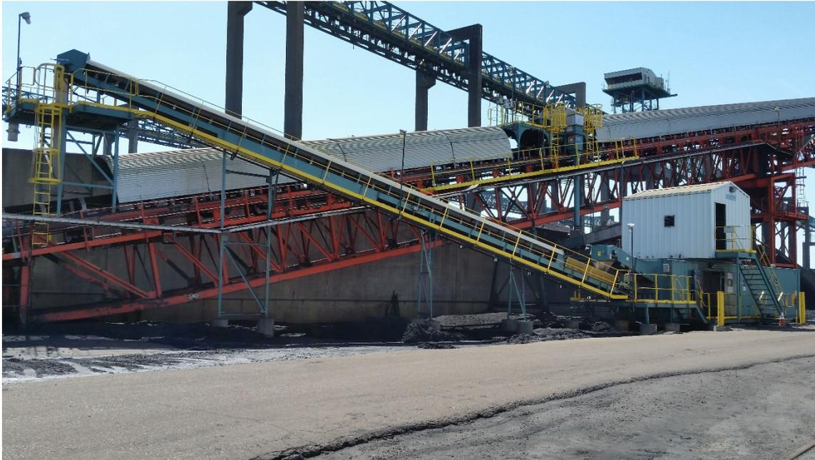
システムの主要コンポーネント一覧は下記に記載されます。**75mm×0 (3 in.×0)** またはそれ未満の製品を取り扱う際は **ASTM 規格以上** で作動します。試料採量方式は複数のベルト速度や切削頻度に設定でき、最小 **1,000 トン** の積送品の特別な試料要望に対応できます。
