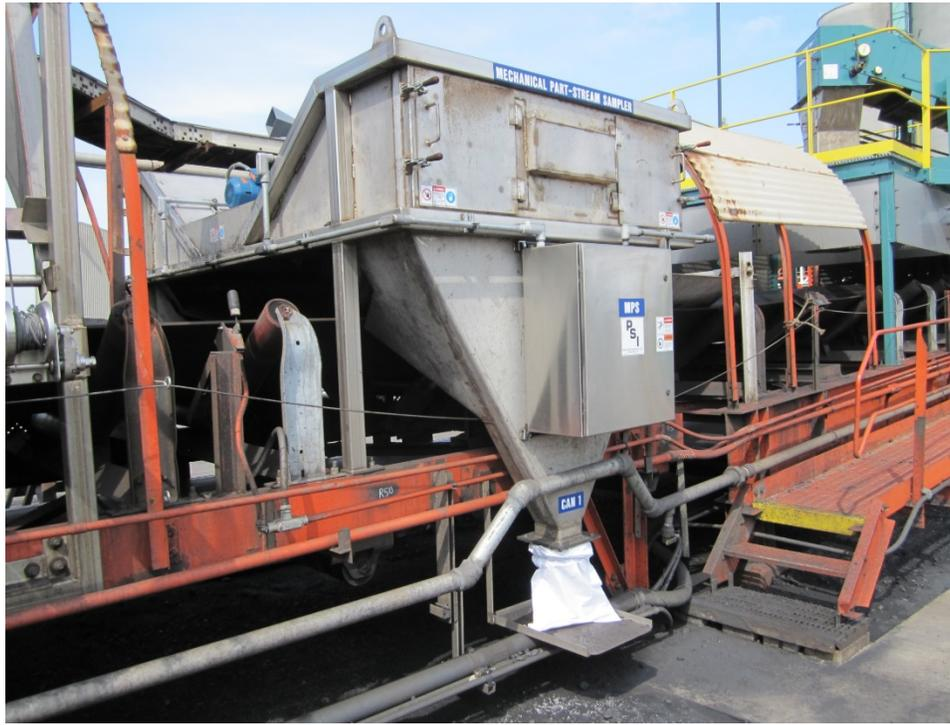
機械式部分流動試料採取機 (MPS) は主に、AS が作動不可になった場合にご利用いただける機械式試料採量装置の代替品です。この予備試料採量装置があることにより、人がコンベヤの外にて手で試料を採取する必要がなくなり、そういった試料採量方法に起因する潜在的危険を避けることができます。MPS は AS と連携した使用が可能で、サイズ分析またはその他の特別な試験のために粉碎されていない余分な試料資材を収集することもできます。
