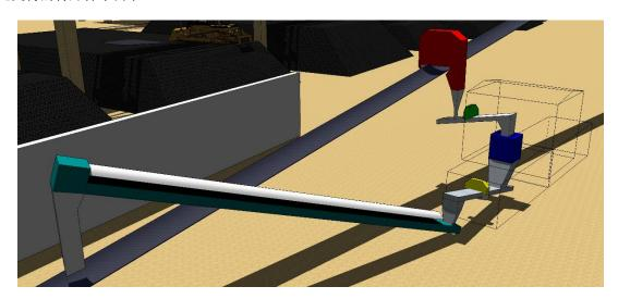
初级取样器 — 这个交叉带式组件(红色)会至少以 1.5 倍于 C-3 传输机 (黑色)的速度运行,因为它每 50 秒会提取 50 千克(111 磅)的子样。切割器开口宽度为 230 毫米(9.2 英寸)。紧塞斜槽的指示器和振动器安装在此组件的传送溜槽上,用来帮助材料的输送。样本材料会以重力给料方式传送到初级给料传输机。
