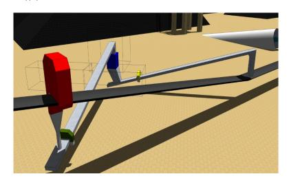
**初级取样器** — 这个交叉带式组件(红色)会至少以 1.5 倍于 C-8 传输机(黑色)的速度运行,因为它每 35 秒会提取 47.6 千克(105 磅)的子样。切割器开口宽度为 233 毫米(9.3 英寸)。每个初级子样都会以重力给料方式传送到初级给料传输机。紧塞斜槽的指示器和振动器安装在此组件的传送溜槽上,用来帮助材料的输送。
