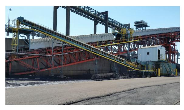
系统的主要组件列于下方,在接受尺寸不超过 75 毫米  $\times$  0 (3 英寸  $\times$  0) 的产品时可正常运行,以满足或超出 ASTM 标准。采样系统可经过调节以多个带速和切割机频率运行,从而适应直至 1,000 吨交付的特殊样本需求。
