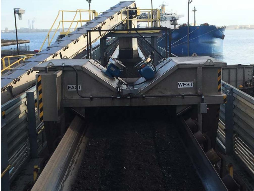
機械式部分流動試料採取機 (MPS) は主に、AS が作動不可になった場合にご利用いただける機械式試料採量装置の代替品です。この予備試料採量装置があることにより、人がコンベヤの外にて手で試料を採取する必要性がなくなり、そういった試料採量方法に起因する潜在的危険を避けることができます。MPS は AS と連携してご利用いただけ、サイズ分析またはその他の特別な試験のために粉碎されていない余分な試料資材を収集することもできます。
