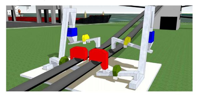
主要試料採取機-このクロスベルト・コンポーネント(レッド)は主要コンベヤ(B または B1)(ダークグレー)の最低 1.5 倍の速度で作動し、40 秒毎に 90kg (200 lbs)のインクリメントを取り出します。切削工具の開口部は幅 225mm (9 in.) です。各インクリメントは主要フィーダーコンベヤに自重送りされます。施栓シュート指示計および振動子が、資材の流れを促すためにこのコンポーネントの乗り移りシュートに設置されています。
