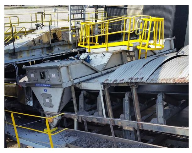
2 台の機械式部分流動試料採取機 (MPS) は主に、対応する B または B1 機械式試料採量方式が作動不可になった場合にご利用いただける機械式試料採量装置の代替品です。この予備試料採量装置があることにより、人がコンベヤの外にて手で試料を採取する必要性がなくなり、そういった試料採量方法に起因する潜在的危害を避けることができます。 MPS は MSS と連携してご利用いただけ、サイズ分析またはその他の特別な試験のために粉砕されていない余分な試料資材を収集することもできます。
