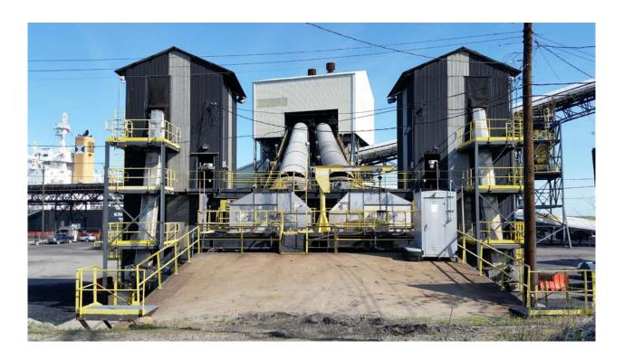
システムの主要コンポーネント一覧が下記に記載されます。75mm x 0 (3 in. x 0) またはそれ未満の製品を受け入れる際は ASTM 規格以上で作動します。両システムの操作プログラムは一定を保ち、一般的に5.000 または10.000 トンのロットで試料を採取するカーゴに対応します。
